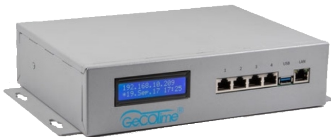
GeCOTime-WAM im Metallgehäuse Produktmaß: 28 x 18 x 6,5cm
